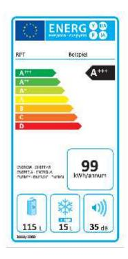
Betrachtet man das Energielabel, ist die Effizienzklasse die augenfälligste Angabe. Sie ist farblich abgestuft. Die ursprüngliche Einteilung bei der Einführung der Label sah hierfür eine Skala von A (grün, beste Klasse) bis G (rot, schlechteste Klasse) vor. Durch den technischen Fortschritt wurden aber im Laufe der Zeit für
